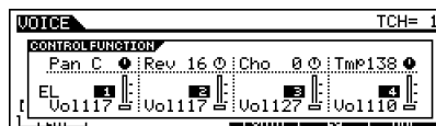
例: パン&エフェクトセンド&テンポが選択された場合のLCD表示
